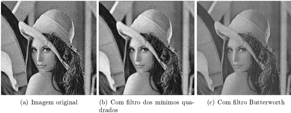
Figura 2: Filtragens para frequência de corte igual a 2 rad/s
