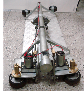
Figura 10. Robô para Inspeção de Linhas de Alta-tensão Subterrâneas Utilizado nos Testes.
