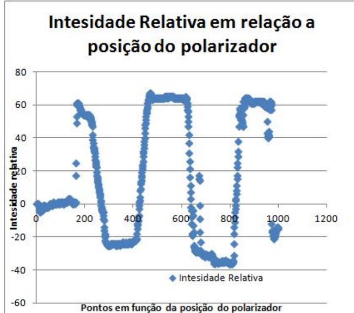
**Figura 11. Padrão de intensidade em função da posição do polarizador obtido com o sensor de Polarização. Os dados estão transladados para o zero de modo que o valor de 153 (posição em que os dois sensores recebem luz sem polarização alguma) foi considerado o ponto zero de medida.**
